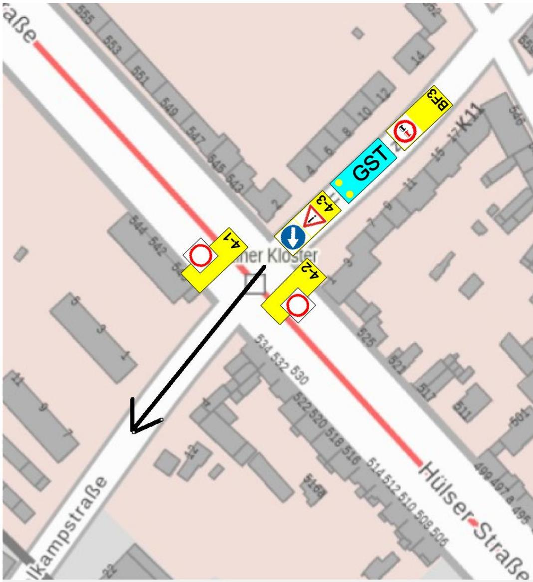
Nachdem die Sperrungen erfolgt sind, fahren das BF4-3, der GST und das BF3 über die Kreuzung Hülser Str. auf die Siempelkampstr. und bleiben stehen. Die Sperrungen werden aufgehoben.
