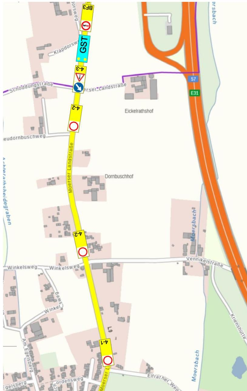
Nachdem die Sperrungen erfolgt sind, fahren das BF4-3, der GST und das BF3 zu BF4-2 und bleiben stehen. Danach hebt das BF4-2 die Sperrung auf und fährt zum nächsten Sperrpunkt. Der Konvoi folgt. usw. Sobald der GST das BF4-1 erreicht hat, hebt das BF4-1 die Sperrung auf.
