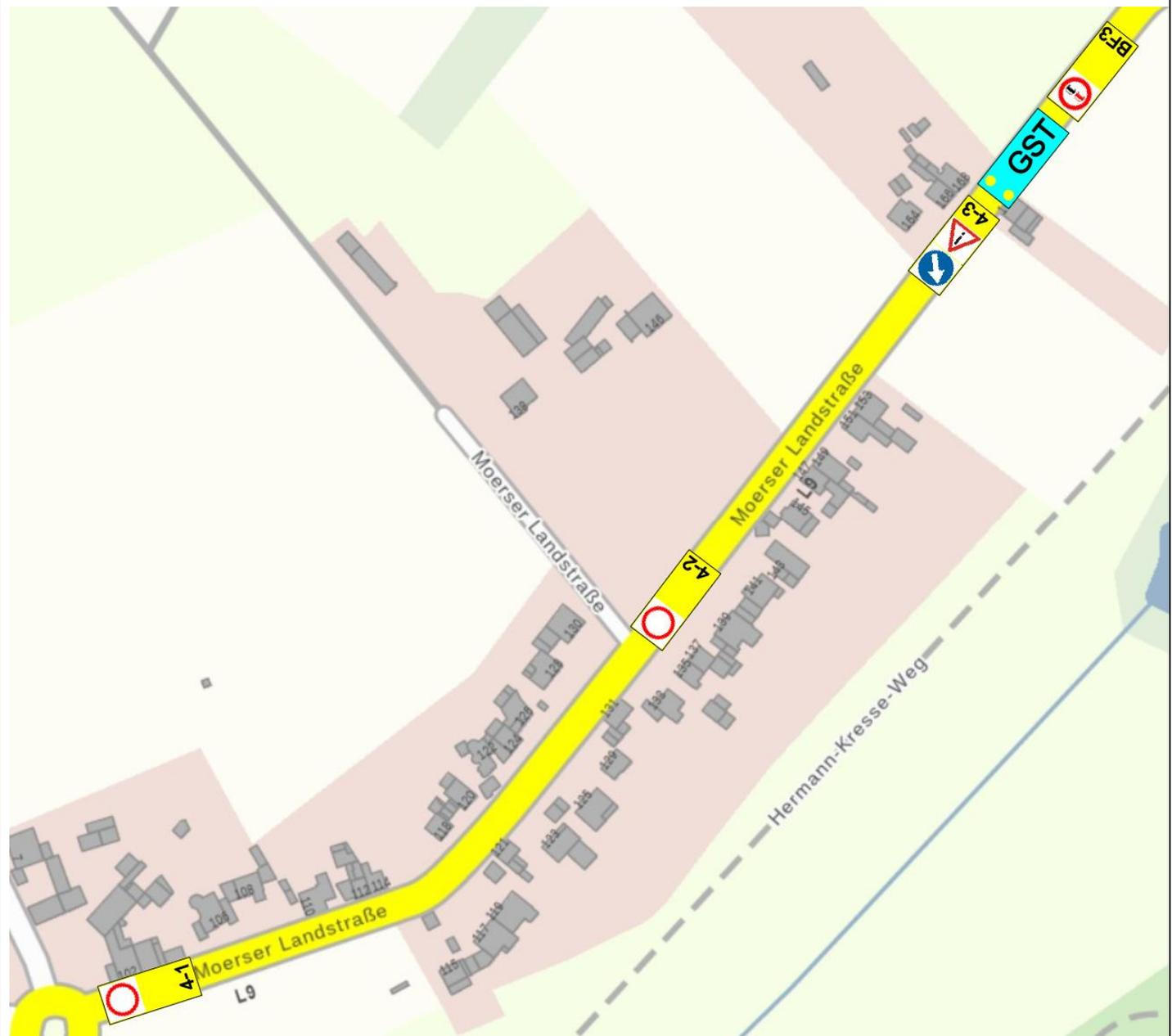
Nachdem die Sperrung erfolgt ist, fahren das BF4-2, das BF4-3, der GST und das BF3 zu BF4-1. Die Sperrung wird aufgehoben.
