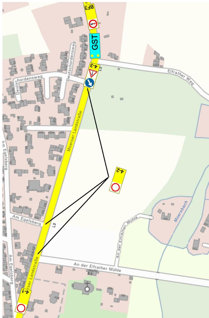
Nachdem die Sperrungen erfolgt sind, fahren das BF4-3, der GST und das BF3 zu BF4-2 und bleiben stehen. Danach hebt das BF4-2 die Sperrung auf und fährt zum nächsten Sperrpunkt. Der Konvoi folgt. usw. Sobald der GST das BF4-1 erreicht hat, hebt das BF4-1 die Sperrung auf.
