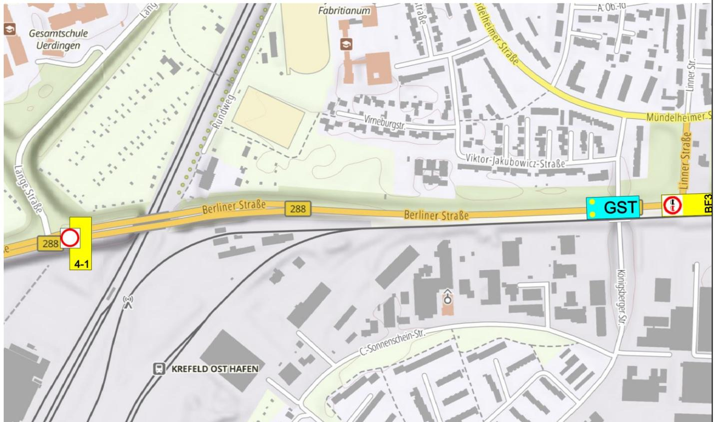
Nachdem die Sperrung erfolgt ist, fährt der GST gemäß der Auflage über die Brücke. **Das Bfz4 hält so viel Abstand, dass eine ggf. angeordnete Alleinfahrt gewährleistet ist.**
