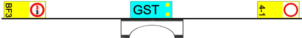
Nachdem die Sperrung erfolgt ist, fährt der GST gemäß der Auflage der Transportgenehmigung über die Brückenbauwerke. Das Bfz4 hält so viel Abstand, dass eine angeordnete Alleinfahrt gewährleistet ist.
