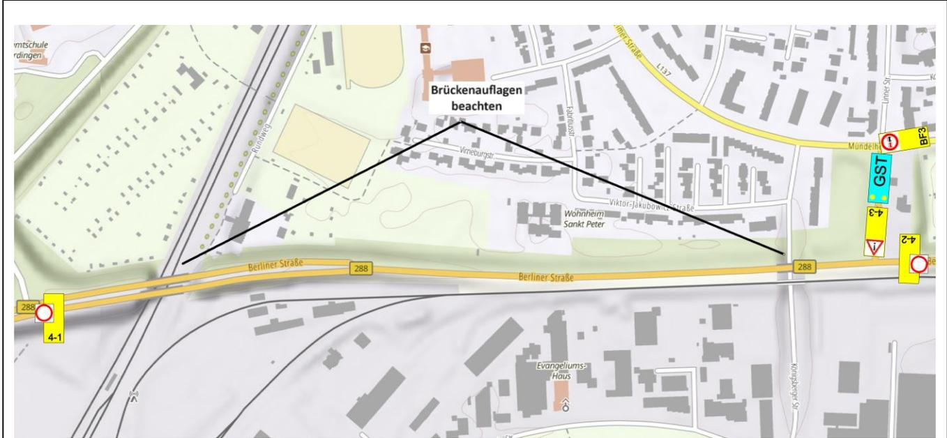
Nachdem die Sperrungen erfolgt sind, fahren der GST und das BF3 zu BF4-1. Die Sperrungen werden aufgehoben. **Bei Brückenauflagen halten das BF4-3 und das BF3 soviel Abstand, dass eine evt. angeordnete Alleinfahrt über die Brückenbauwerke gewährleistet ist.**
