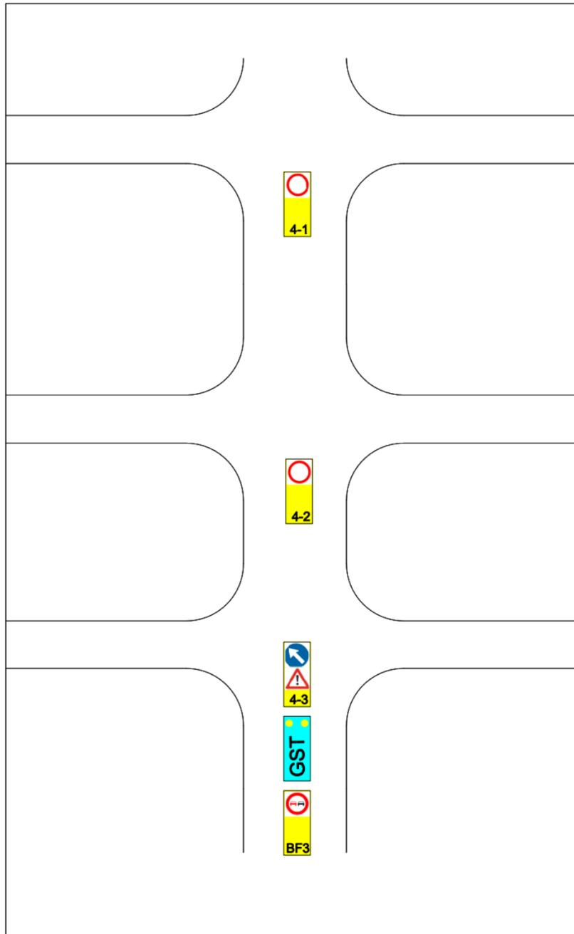
Nachdem die Sperrungen erfolgt sind, fahren das BF4-3, der GST und das BF3 zu BF4-2 / BF4-1 und bleiben stehen. Danach hebt das BF4-2 / BF4-1 die Sperrung auf und fährt zum nächsten Sperrpunkt. Der Konvoi folgt. usw.
