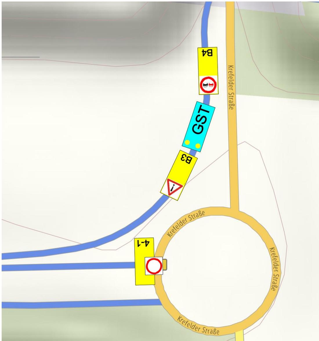
Nachdem die Sperrung erfolgt ist, fahren das BF4-3 der GST und das BF3 auf die BAB. Die Sperrung wird aufgehoben.
